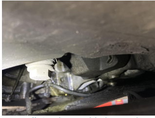
Yağ Sızdırmazlık (Motor)
